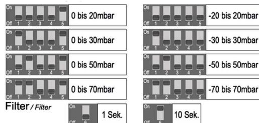
Der Dipswitch-Nr. 6 dient als Filter für die Stabilisierung des Druckmesssignals. In OFF-Stellung findet eine Abfrage im Zeitintervall von 1 Sekunde statt. In ON-Stellung wird das Abfrageintervall auf 10 Sekunden erhöht und somit das Signal geglättet.
